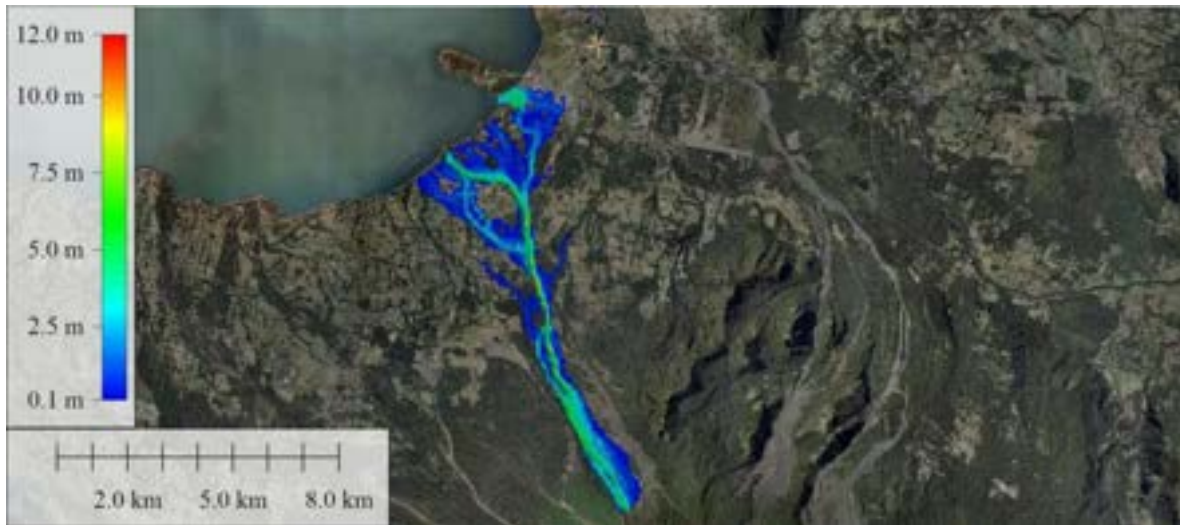
Figura Nº 2-9 Evento 1 cuenca Zanjón Seco, altura de inundación
